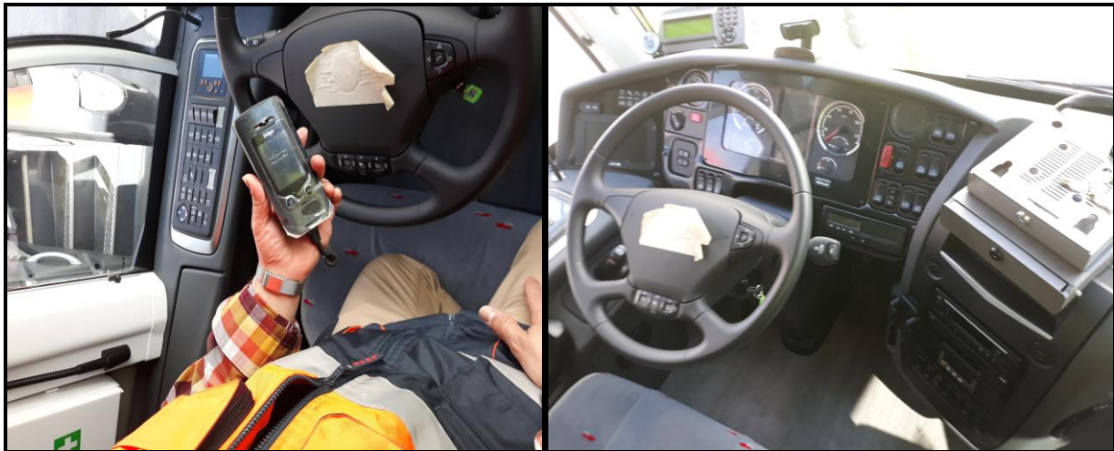
A direita bafômetro e a esquerda aparelho que envia dados ao Ministerio do Fomento.
