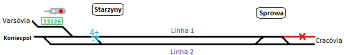
Figura 17 – O sinal provisório é acionado
